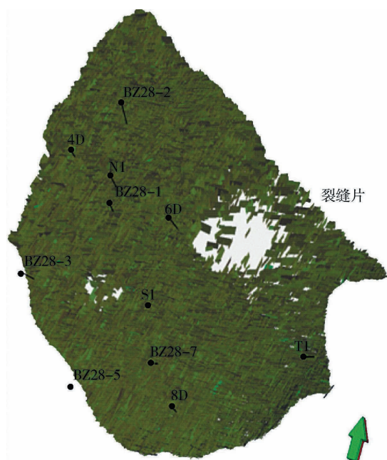
图8 古潜山碳酸盐岩裂缝片三维模型(DFN)
