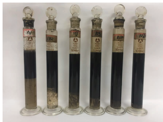
图7 0.4% HWSX-1 表面活性剂与 AB-6 井原油乳化后析水结果
