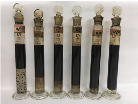
图 11 0.5% HWSX-1 表面活性剂与 B-41 井原油乳化后析水结果
