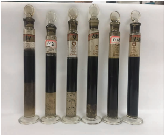
图 9 0.3% HWSX-1 表面活性剂与 AB-7 井原油乳化后析水结果
