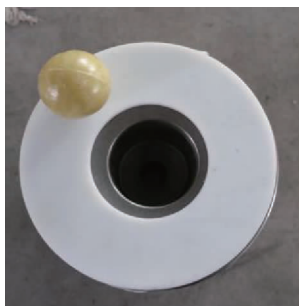
图3 暂堵球在模拟射孔炮眼装置承压试验
