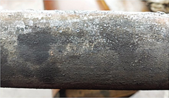
图1 S2-10井腐蚀油管外壁
