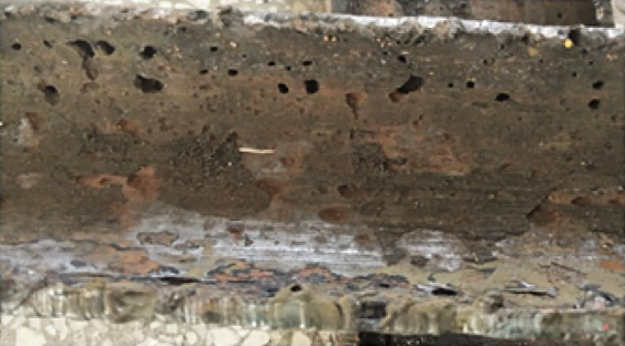
图2 S2-10井腐蚀油管内壁
