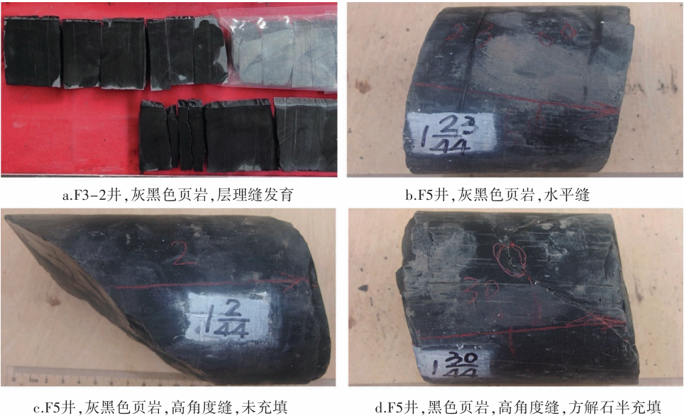
图3 涪陵区块凉高山组泥页岩裂缝照片
