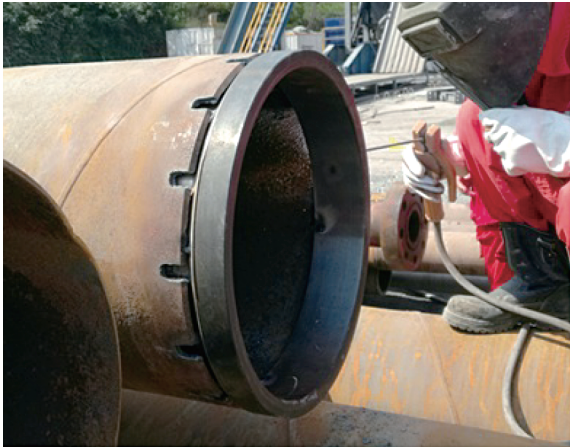
图2 在卷管上焊接管鞋
