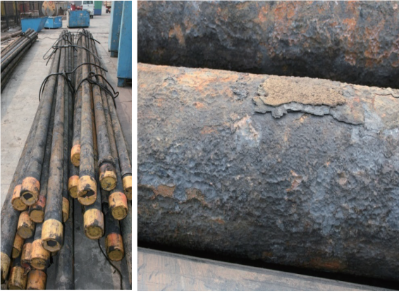
图3 作业后腐蚀油管
