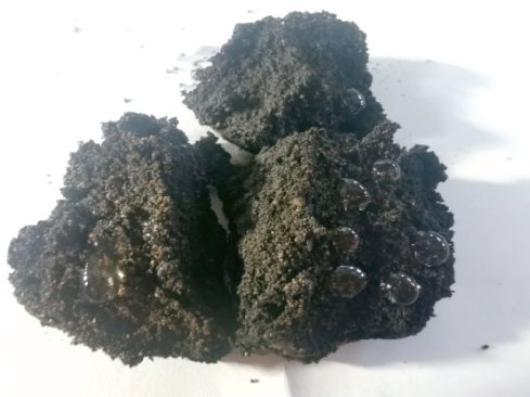
图9 排601-浅5岩心照片(深度523 m,含油饱和度65%)
