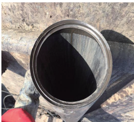
图1 割断的套管本体切剖面
